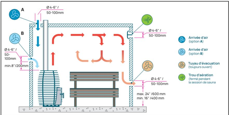
Figure 12. Ventilation mécanique dans le sauna avec un poêle à bois.
