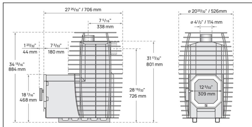
Figure 2. Dimensions du poêle HIVE Flow LS
