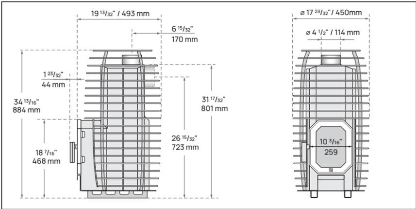
Figure 3. Dimensions du poêle HIVE Flow Mini
