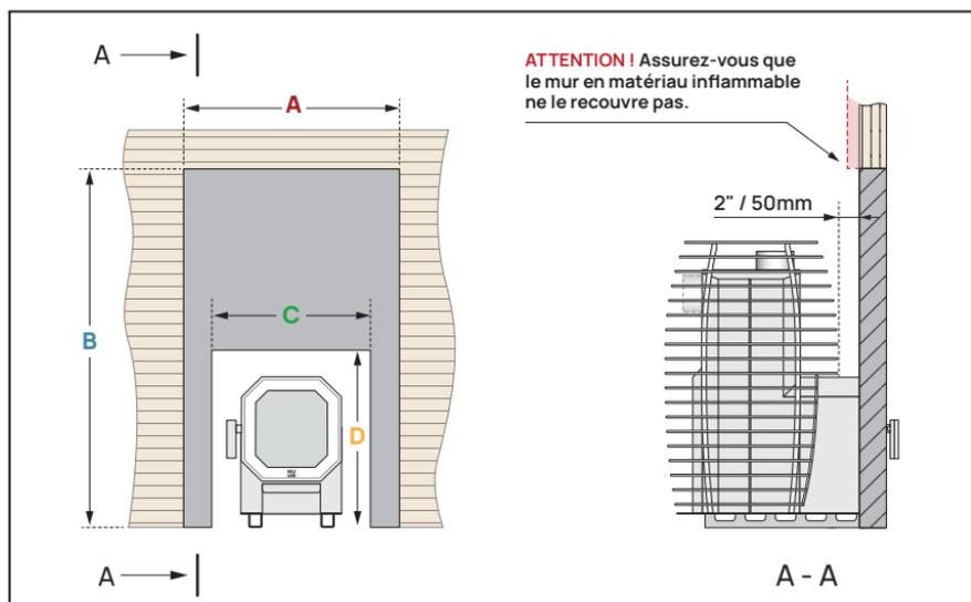
Figure 9. Installation des poêles HIVE Flow LS et Flow Mini LS à travers le mur..
