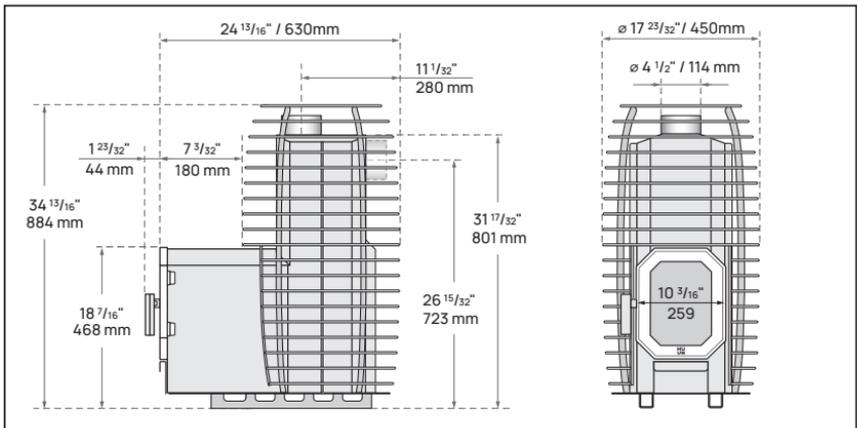
Figure 4. Dimensions du poêle HIVE Flow Mini LS
