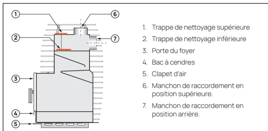
Figure 18. Éléments du poêle pour sauna HIVE Flow
