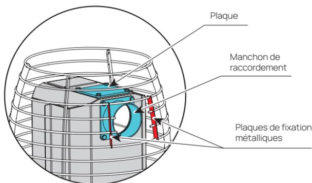
**Figure 10.** Connexion de HIVE Flow au conduit de fumée par l'arrière. Coupez deux nervures en fonction du diamètre de la cheminée et fixez leurs extrémités à l'aide des plaques de fixation métalliques incluses dans le kit.
